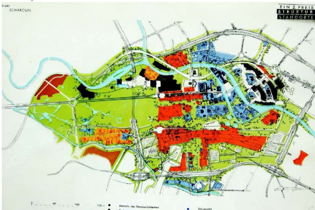
Fig. 9. Uno de los Segundos Premios: el proyecto de Hans Scharoun. El Tiergarten fluye libremente hacia el Este ¡gracias a una red de túneles viales de más de nueve kilómetros de largo! No sólo desaparece la trama de Berlín sino que no hay ninguna. Crea un Centro Cívico con una plaza pavimentada que toma todo el espacio (500 metros) entre el Reichstag y la Sala de Congresos. La ribera sur del Spree es modificada en dos puntos. A lo largo de Leipzigerstrasse propone lo que llama "la colina", un conjunto compacto destinado a albergar actividades económicas
