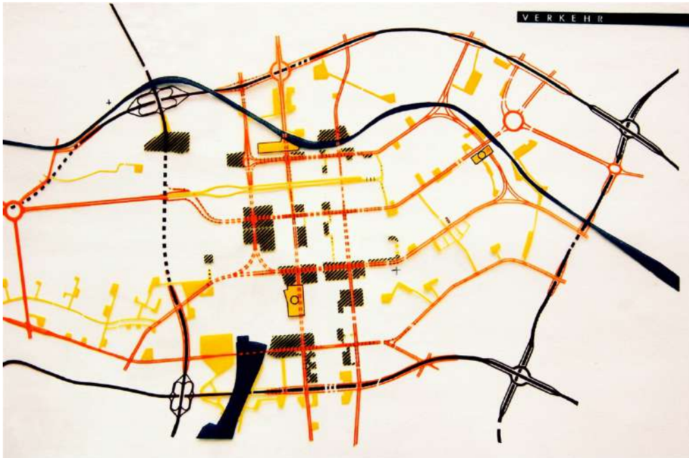
Fig. 27. Uno de los Segundos Premios (Hartmann). Propone túneles para conectar 17 Juni Strasse con Französischerstrasse así como para pasar por debajo de la nueva Leipzigerplatz. Un distribuidor de tráfico se coloca directamente frente al Reichstag.
